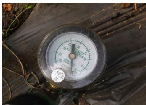
Figure 8.4. Tensiomètre manuel
